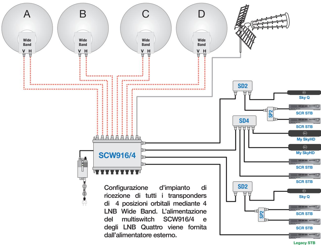
Configurazione d'impianto di ricezione di tutti i transponders di 4 posizioni orbitali mediante 4 LNB Wide Band. L'alimentazione del multiswitch SCW916/4 e degli LNB Quattro viene fornita dall'alimentatore esterno.
