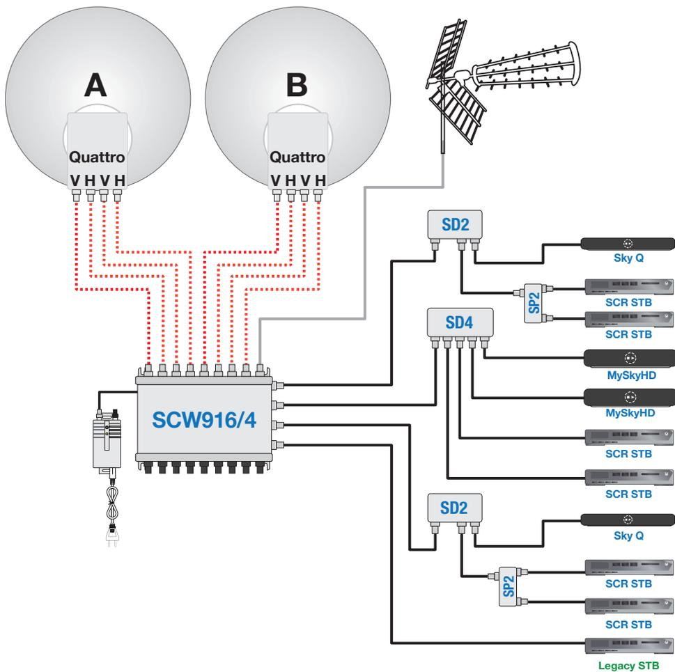
Sistema di ricezione per doppia posizione orbitale mediante 2 LNB Quattro standard. L'alimentazione del multiswitch SCW916/4 e degli LNB Quattro viene fornita dall'alimentatore esterno.
