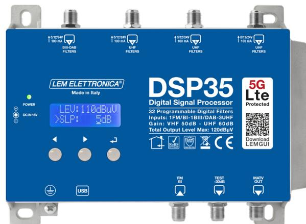
Centrale di amplificazione multi-ingresso con filtri digitali programmabili per l'equalizzazione e la conversione in frequenza di MUX DVB-T/T2.
