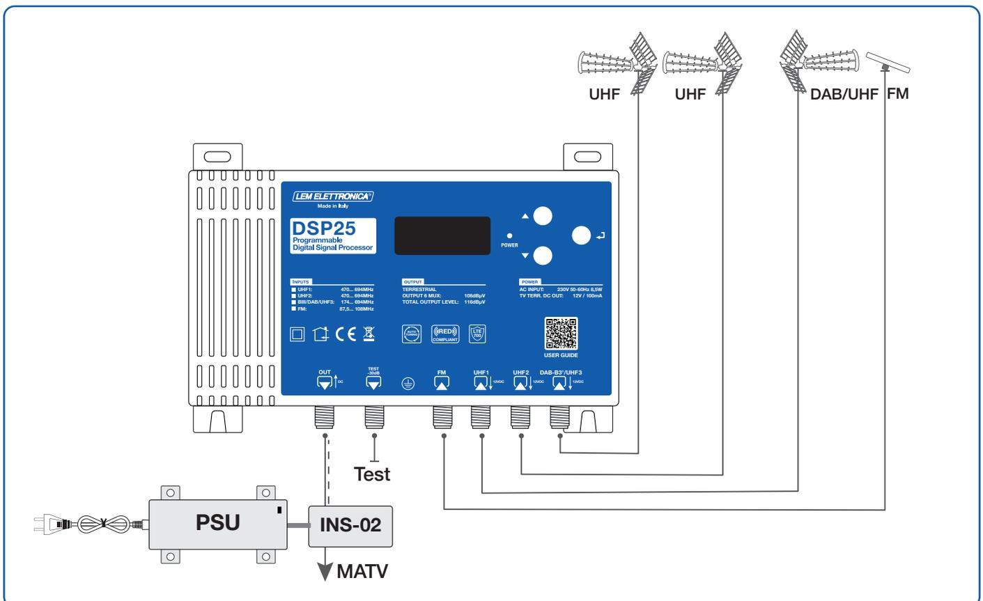
In situazioni dove non sia disponibile una presa di rete la centrale **DSP25** può essere alimentata da remoto tramite il cavo coassiale del montante di uscita.
