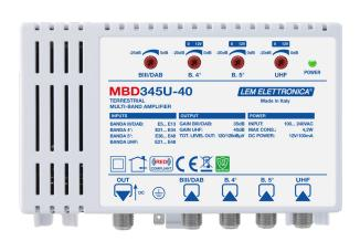
Centralino per amplificazione TV multi-ingressi da interno autoalimentato con amplificazione a bassa figura di rumore. 4 Ingressi con guadagno regolabile e **telealimentazione protetta da corto circuiti auto ripristinante**.
