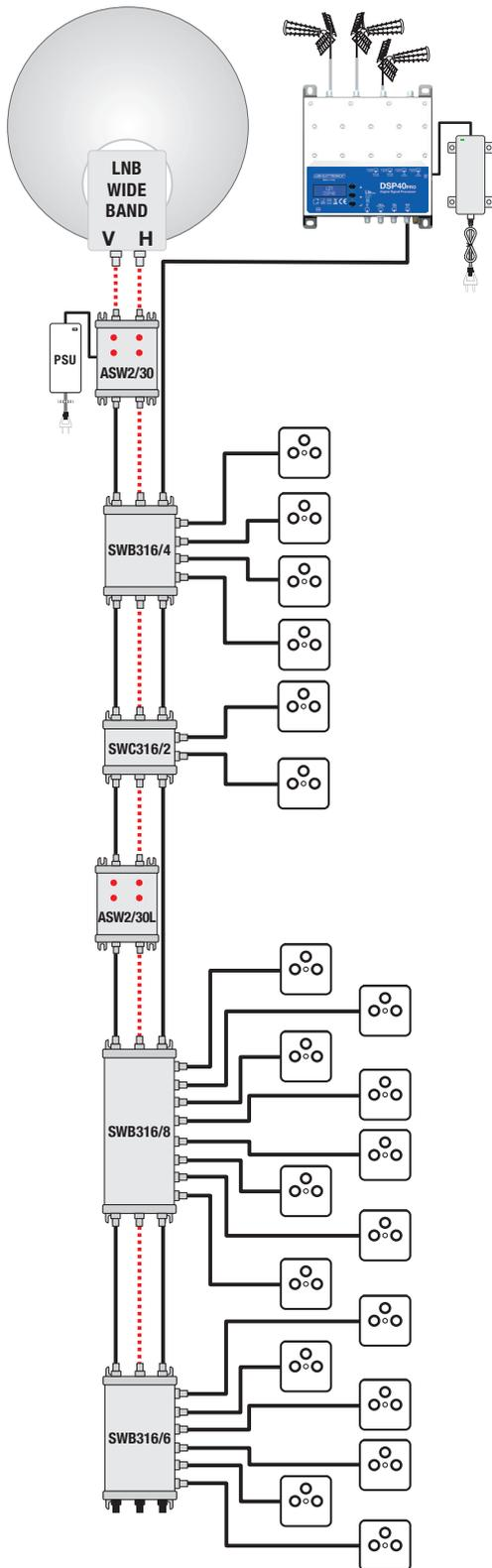
► Esempio di distribuzione in cascata per un singolo satellite con alimentazione dell'LNB e dell'amplificatore di linea **ASW2/30L** fornita dall'amplificatore di testa **ASW2/30**.
