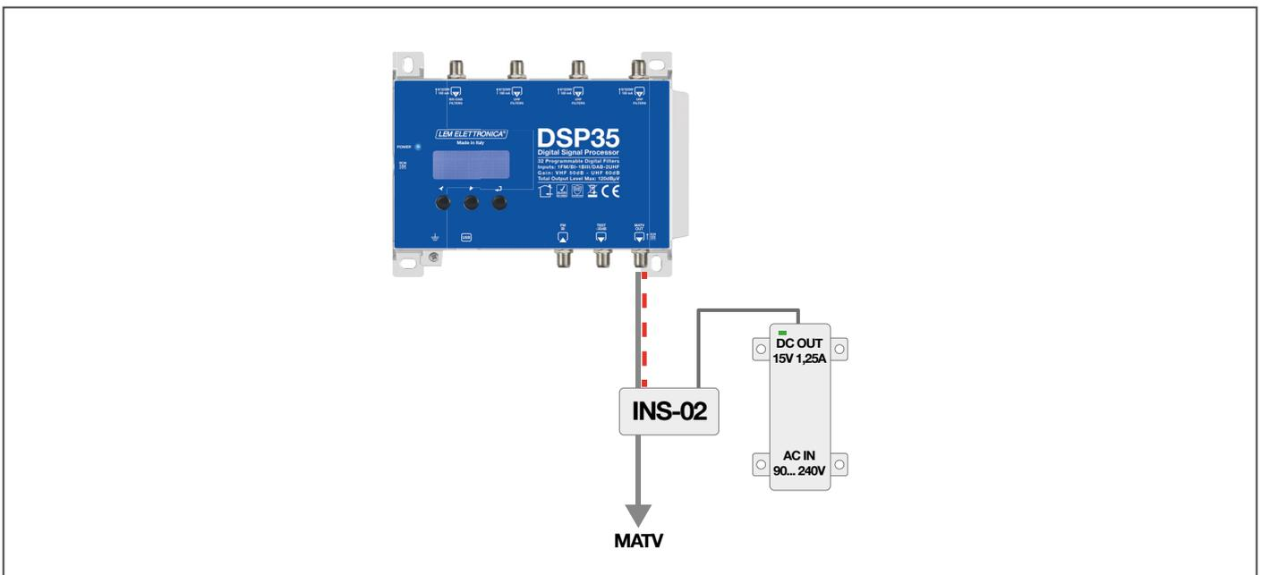
Esempio di applicazione dell'inseritore di tensione **INS-02** per l'alimentazione remota dall'uscita MATV dell'amplificatore programmabile **DSP35**.
