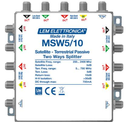
L'MSW5/10 è un divisore passivo a banda estesa per distribuzione Terrestre e Satellite a 4 montanti SAT Wide Band.
