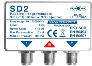
Nei casi in cui due o più decoder condividono la stessa uscita SCR/dCSS gli Smart Splitter assolvono a due importanti funzioni; evitano la “collisione” dei comandi inviati memorizzandoli per poi inviarli nella corretta sequenza ed eliminano le criticità dovute alla diversità di tensioni erogate dai decoder.
