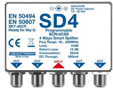
Nei casi in cui due o più decoder condividono la stessa uscita SCR/dCSS gli Smart Splitter assolvono a due importanti funzioni; evitano la “collisione” dei comandi inviati memorizzandoli per poi inviarli nella corretta sequenza ed eliminano le criticità dovute alla diversità di tensioni erogate dai decoder.
