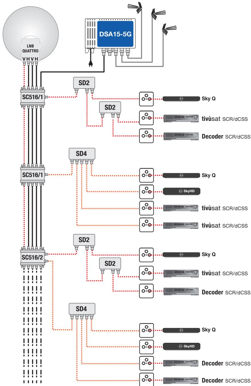
► Per impianti di piccole dimensioni realizzati con uno o più multiswitch della serie **SC516**, se il segnale d'ingresso ai multiswitch risulta essere superiore a 60dBµV può non essere necessario utilizzare l'amplificatore di testa. L'alimentazione dell'LNB Quattro viene fornita direttamente dai decoder.
