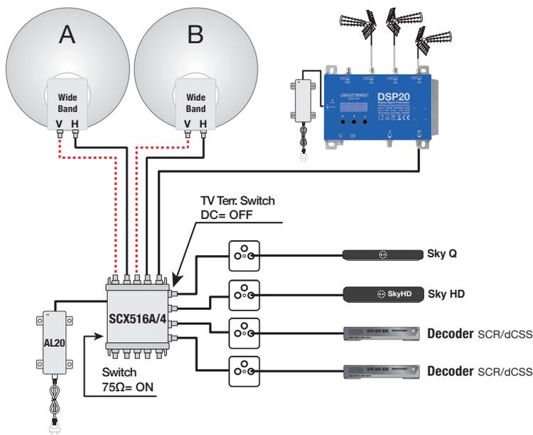
► Esempio di distribuzione radiale con un singolo multiswitch serie **SCX516A** con la miscelazione attiva dei segnali terrestri per la ricezione di due satelliti. **La terminazione a 75Ohm delle uscite passanti viene realizzata elettronicamente dal multiswitch.**
