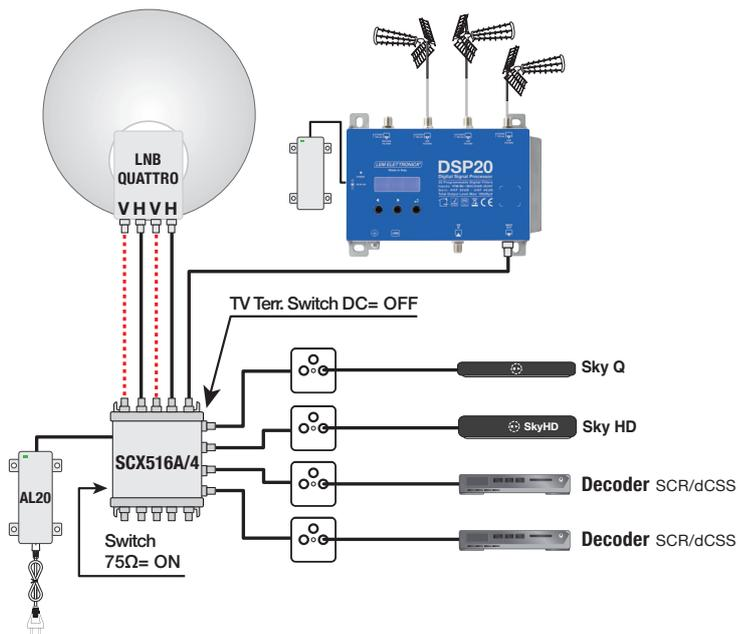
► Esempio di distribuzione radiale con un singolo multiswitch serie **SCX516A** con la miscelazione attiva dei segnali terrestri per la ricezione di un singolo satellite. **La terminazione a 75Ohm delle uscite passanti viene realizzata elettronicamente dal multiswitch.**
