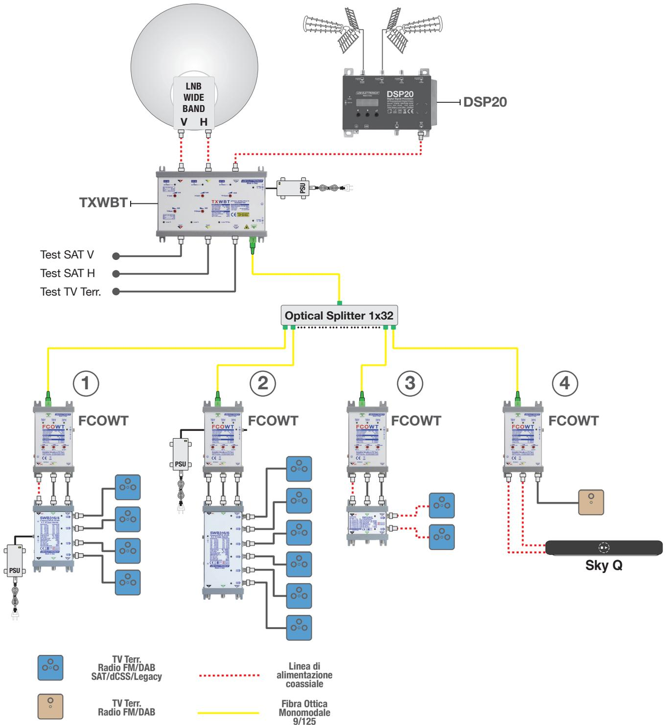
**Distribuzione dei segnali di un satellite e della TV terrestre tramite una singola fibra ottica monomodale mediante ricevitori ottici FCOWT con uscite wide band.**
