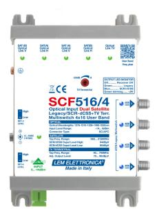
Multiswitch ad ingresso ottico con 4 uscite Legacy/dCSS per la distribuzione di tutti i transponders satellitari di due posizioni orbitali e dei servizi terrestri DVB-T/T2, FM, DAB tramite una singola fibra monomodale.
