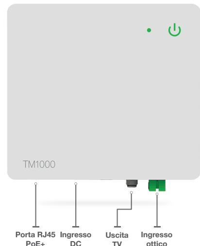
**ONT multiservizio professionale** per la ricezione dei servizi IP di una rete GPON e delle trasmissioni della TV Terrestre mediante una singola fibra ottica. La **funzione PoE integrata** semplifica le installazioni che tipicamente richiedono l'alimentazione remota, come: videocitofoni IP, telecamere IP, access point.
