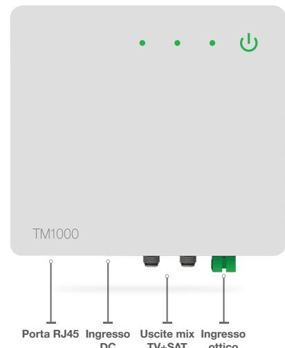
**ONT multiservizio professionale** per la ricezione dei servizi IP di una rete GPON e delle trasmissioni TV Satellitare e Terrestre mediante una singola fibra ottica.
