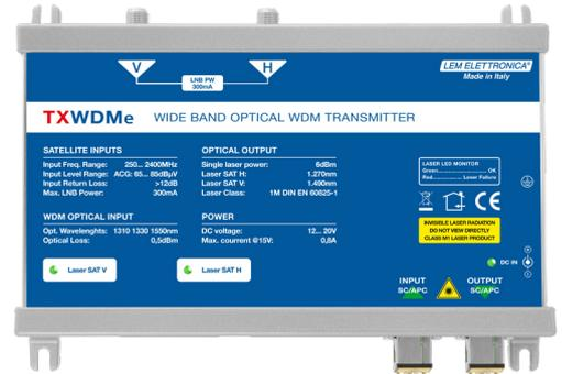
Trasmittitore ottico a due lunghezze d'onda con **ingresso CWDM integrato**. Adatto per essere utilizzato in abbinamento ad un trasmettitore **TXWBTe** o **TXWBe** per realizzare distribuzioni di due posizione orbitali satellitari mediante una singola fibra ottica monomodale.
