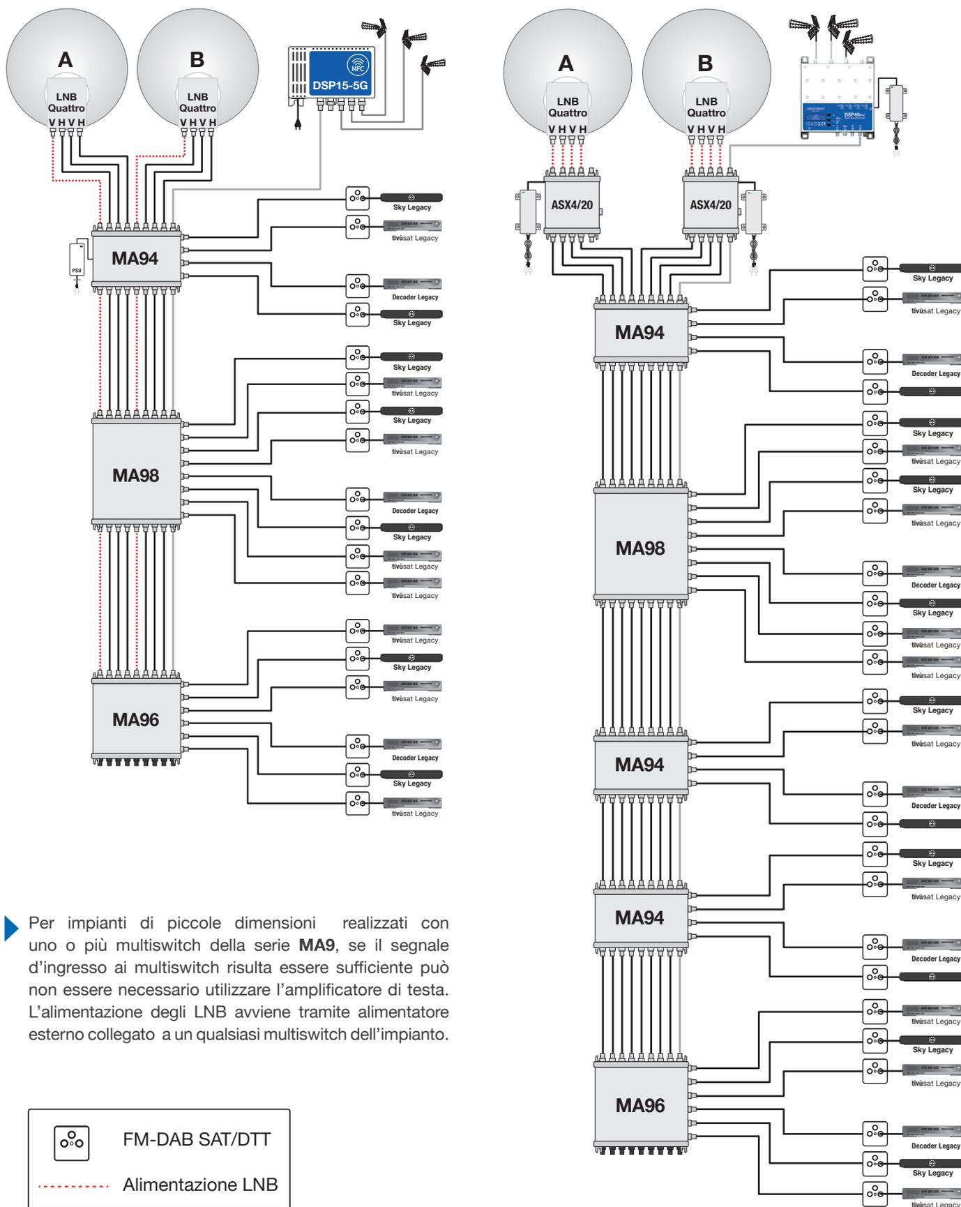
► Per impianti di piccole dimensioni realizzati con uno o più multiswitch della serie **MA9**, se il segnale d'ingresso ai multiswitch risulta essere sufficiente può non essere necessario utilizzare l'amplificatore di testa. L'alimentazione degli LNB avviene tramite alimentatore esterno collegato a un qualsiasi multiswitch dell'impianto.
