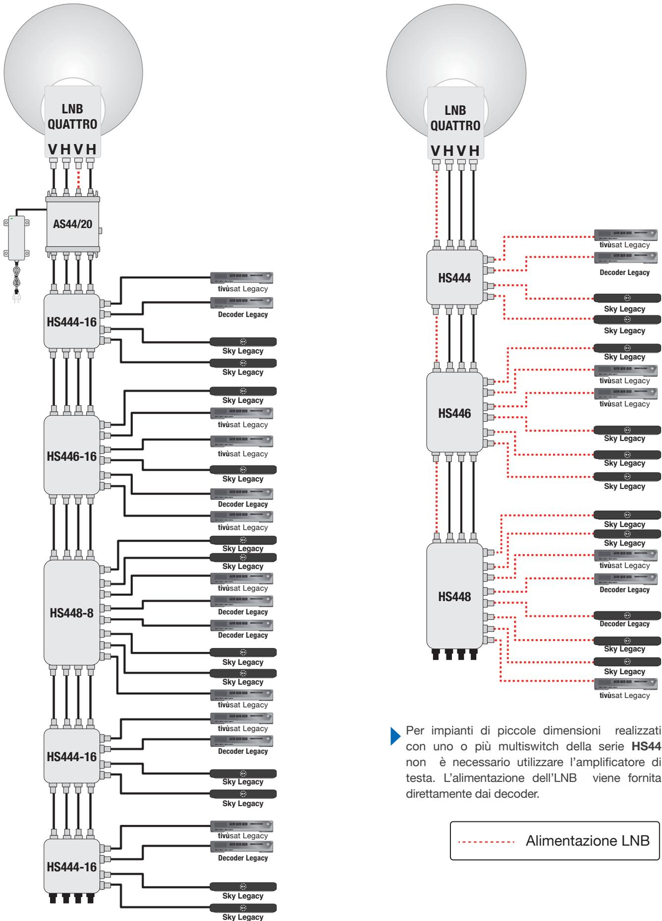
▶ Per impianti di piccole dimensioni realizzati con uno o più multiswitch della serie **HS44** non è necessario utilizzare l'amplificatore di testa. L'alimentazione dell'LNB viene fornita direttamente dai decoder.
