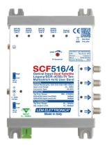
Multiswitch ad ingresso ottico con 2 o 4 uscite Legacy/dCSS per la distribuzione di tutti i transponders satellitari di due posizioni orbitali e dei servizi terrestri DVB-T/T2, FM, DAB tramite una singola fibra monomodale.
