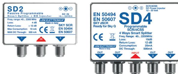
Nei casi in cui due o più decoder condividono la stessa uscita SCR/dCSS gli Smart Splitter assolvono a due importanti funzioni; **evitano la “collisione” dei comandi inviati memorizzandoli per poi inviarli nella corretta sequenza ed eliminano le criticità dovute alla diversità di tensioni erogate dai decoder.**
