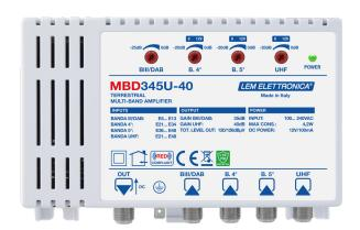
Centralino per amplificazione TV multi-ingressi da interno autoalimentato con amplificazione a bassa figura di rumore. Guadagno regolabile per tutti gli ingressi e tele-alimentazione dagli ingressi UHF con protezione da corto circuito.
