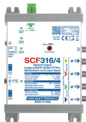
Multiswitch ad ingresso ottico con 4 uscite Legacy/dCSS per la distribuzione di tutti i transponders satellitari di una posizione orbitale e dei servizi terrestri DVB-T/T2, FM, DAB tramite una singola fibra monomodale. Può anche essere configurato per emulare le uscite di un LNB Quattro VL-HL/VH-HH con uscita TV terrestre separata.
