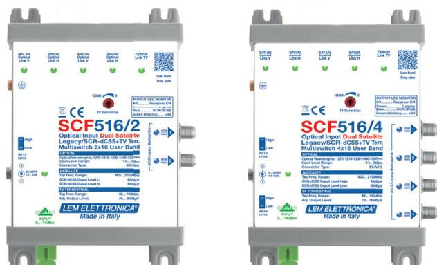
Multiswitch ad ingresso ottico con 2 o 4 uscite Legacy/dCSS per la distribuzione di tutti i transponders satellitari di due posizioni orbitali e dei servizi terrestri DVB-T/T2, FM, DAB tramite una singola fibra monomodale.
