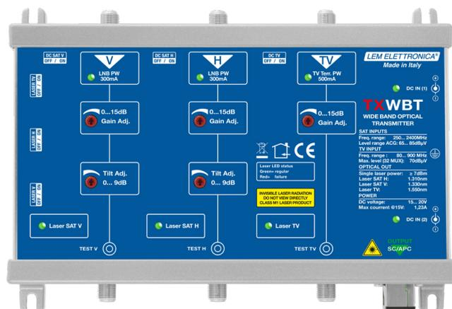
Trasmettitori ottici realizzati con laser **DFB** a bassa distorsione e elevata linearità. Per distribuzioni con una singola fibra ottica monomodale di un'intera posizione orbitale. Disponibili nelle versioni con o senza la TV digitale terrestre e i servizi radio FM e DAB.
