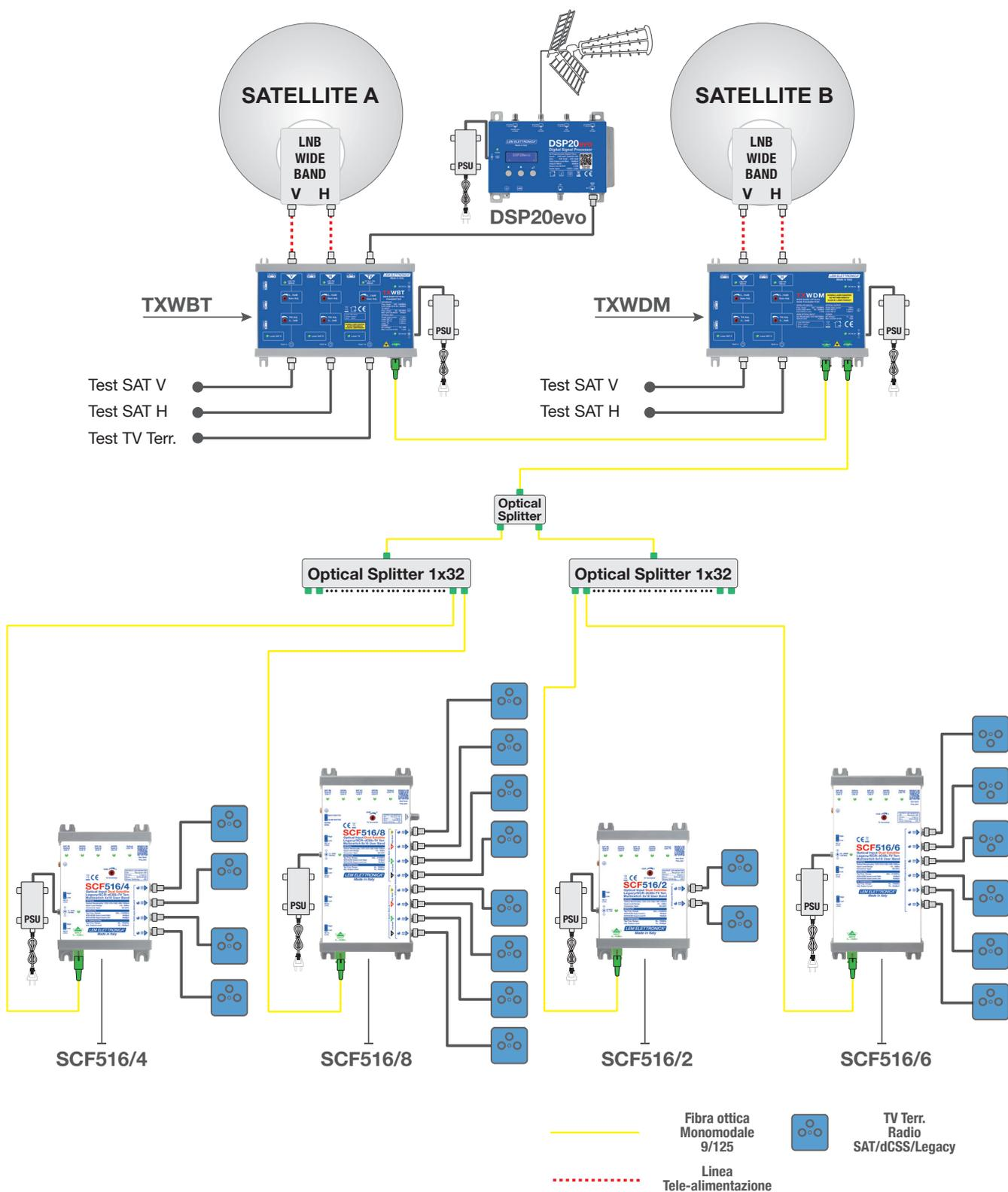
**Distribuzione dei segnali di due satelliti e della TV terrestre tramite una singola fibra ottica monomodale con multiswitch serie SCF516.**
