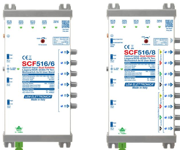
Multiswitch ad ingresso ottico con 6 o 8 uscite Legacy/dCSS per la distribuzione di tutti i transponders satellitari di due posizioni orbitali e dei servizi terrestri DVB-T/T2, FM, DAB tramite una singola fibra monomodale. Il modello SCF516/8 può essere configurato per emulare il funzionamento di 2 LNB Quattro VL-HL/VH-HH con uscita TV terrestre separata.
