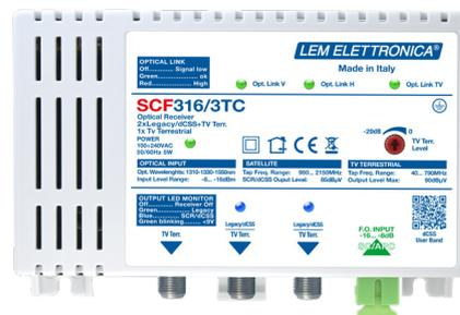
Ricevitore multiswitch ad ingresso ottico per la distribuzione di tutti i transponders satellitari di una posizione orbitale e dei servizi terrestri DVB-T, FM, DAB tramite una singola fibra monomodale. Dispone di 2 uscite satellite (dCSS/Legacy) con TV/FM/DAB miscelate e 1 uscita aggiuntiva TV/FM/DAB.
