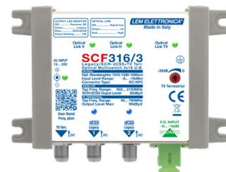
Ricevitore multiswitch ad ingresso ottico per la distribuzione di tutti i transponders satellitari di una posizione orbitale e dei servizi terrestri DVB-T, FM, DAB tramite una singola fibra monomodale. Dispone di 2 uscite satellite (dCSS/Legacy) con TV/FM/DAB miscelate e 1 uscita aggiuntiva TV/FM/DAB.
