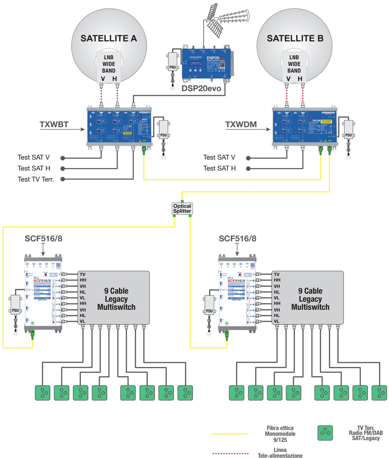
**Distribuzione dei segnali di due satelliti e della TV terrestre tramite una singola fibra ottica monomodale con multiswitch SCF516/8 configurati in modalità LNB Quattro.**
