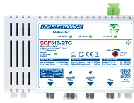
Ricevitore multiswitch ad ingresso ottico per la distribuzione di tutti i transponders satellitari di una posizione orbitale e dei servizi terrestri DVB-T, FM, DAB tramite una singola fibra monomodale. Dispone di 2 uscite satellite (dCSS/Legacy) con TV/FM/DAB miscelate e 2 uscite aggiuntive TV/FM/DAB.
