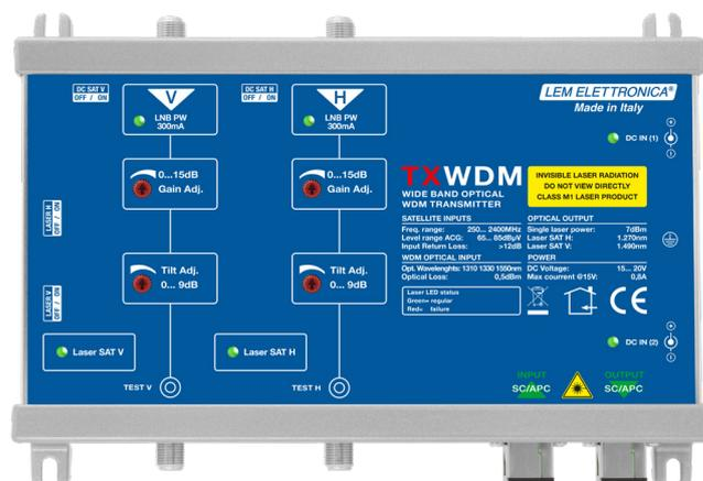
Trasmettitore ottico a due lunghezze d'onda con ingresso CWDM integrato. Adatto per essere utilizzato in abbinamento ad un trasmettitore **TXWBT** o **TXWB** per realizzare distribuzioni di due posizioni orbitali satellitari mediante una singola fibra ottica monomodale.
