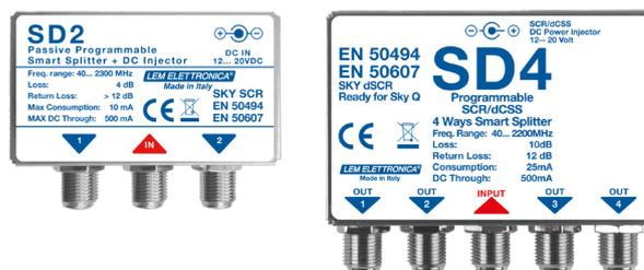
Nei casi in cui due o più decoder condividono la stessa uscita SCR/dCSS gli Smart Splitter assolvono a due importanti funzioni; **evitano la “collisione” dei comandi inviati memorizzandoli per poi inviarli nella corretta sequenza ed eliminano le criticità dovute alla diversità di tensioni erogate dai decoder.**
