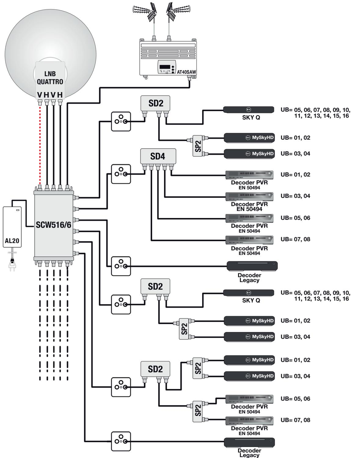
Per impianti di piccole dimensioni realizzati con multiswitch serie **SCW516** se il segnale d'ingresso ai multiswitch risulta essere superiore a 60dB $\mu$ V è possibile omettere l'amplificatore di testa.
