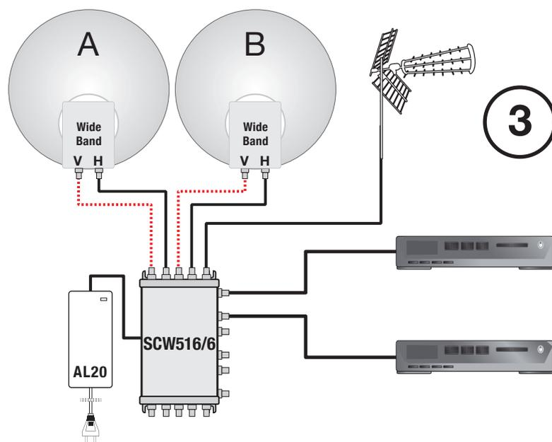
3 L'alimentatore **AL20** alimenta il multiswitch e i due LNB Wide Band tramite le linee delle polarità verticale banda bassa e banda alta.
