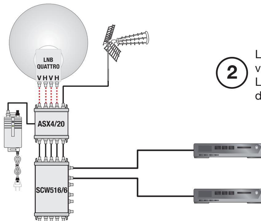
2 L'alimentazione del multiswitch viene fornita dai decoder collegati. L'LNB viene alimentato direttamente dall'amplificatore di testa **ASX4/20**.
