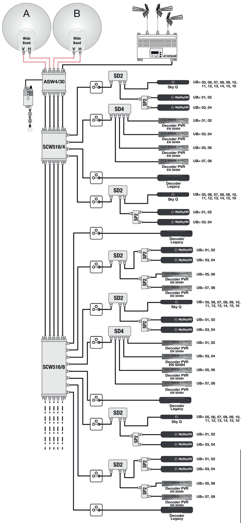
Schema di utilizzo di **SCW516** per la distribuzione in dual feed di due posizioni satellitari.
