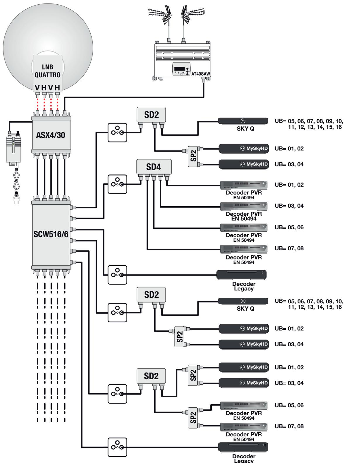
Schema di utilizzo di **SCW516/6** con amplificatore di testa **ASX4/30** che amplifica ed equalizza i segnali della dorsale IF-SAT e provvede all'alimentazione dell'LNB.
