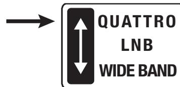
Se l'impianto è stato realizzato con LNB Wide Band posizionare il selettore su WIDE BAND. In questa condizione di utilizzo viene attivata anche la linea di telealimentazione presente sulla polarità Verticale Banda Alta.
