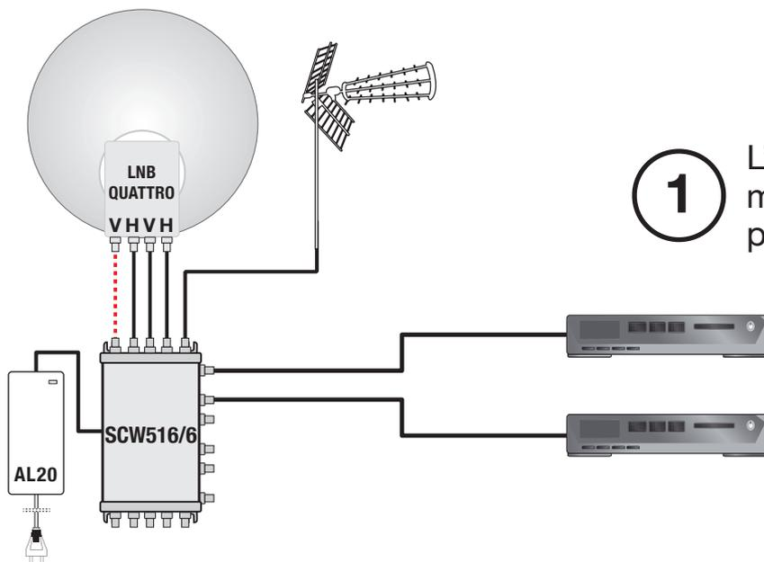
1 L'alimentatore **AL20** alimenta il multiswitch e l'LNB tramite la linea della polarità verticale banda bassa.
