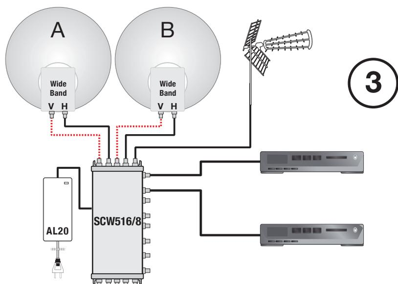
3 L'alimentatore **AL20** alimenta il multiswitch e i due LNB Wide Band tramite le linee delle polarità verticale banda bassa e banda alta.
