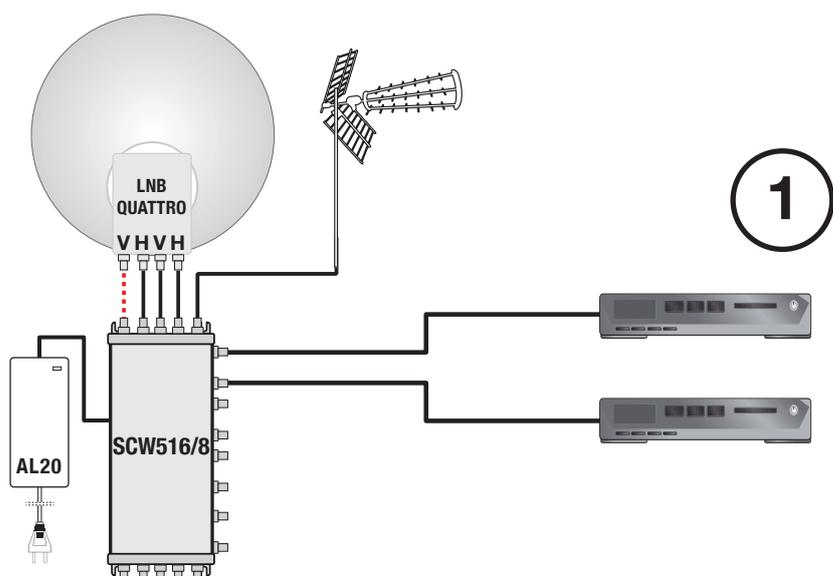
1 L'alimentatore **AL20** alimenta il multiswitch e l'LNB tramite la linea della polarità verticale banda bassa.
