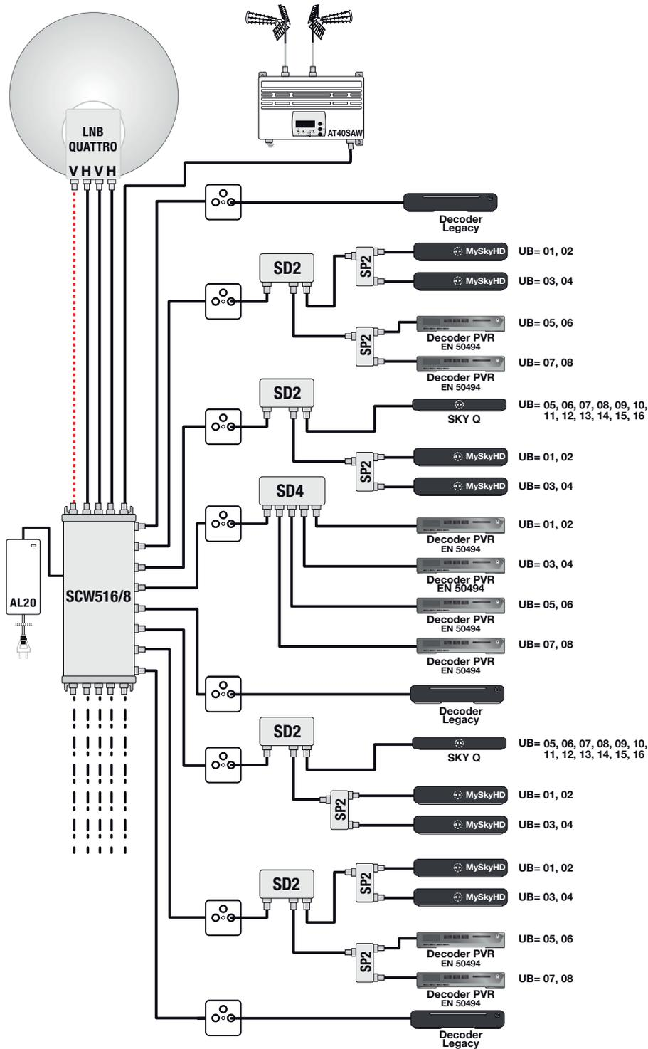
Per impianti di piccole dimensioni realizzati con multiswitch serie **SCW516** se il segnale d'ingresso ai multiswitch risulta essere superiore a  $60\text{dB}\mu\text{V}$  è possibile omettere l'amplificatore di testa.
