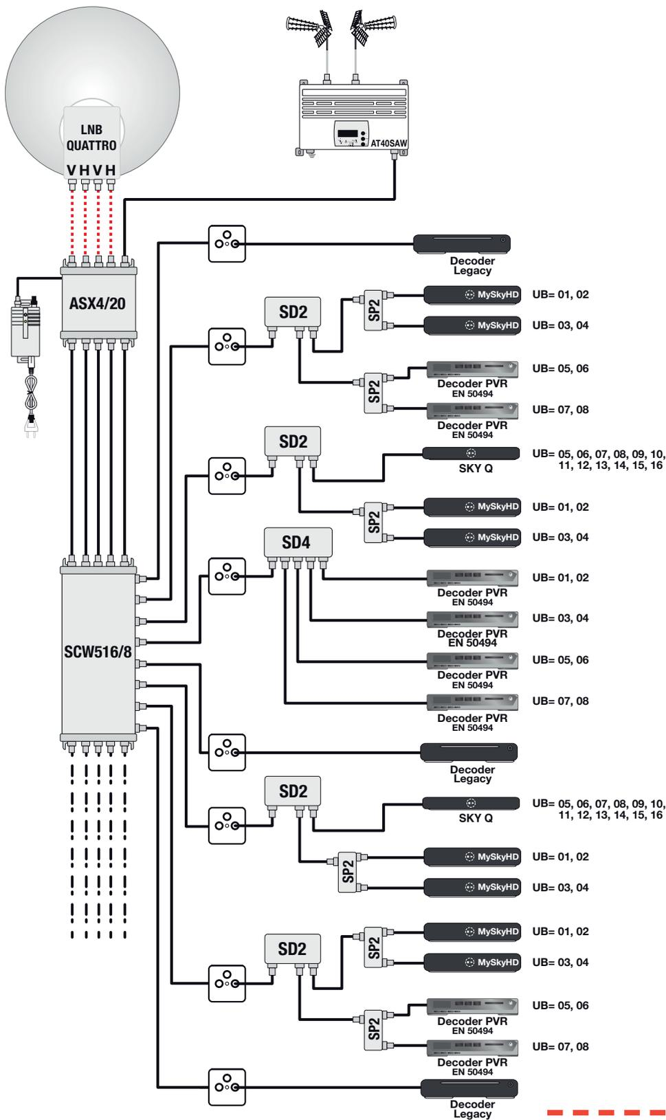
Schema di utilizzo di **SCW516/8** con amplificatore di testa **ASX4/20** che amplifica ed equalizza i segnali della dorsale IF-SAT e provvede all'alimentazione dell'LNB.
