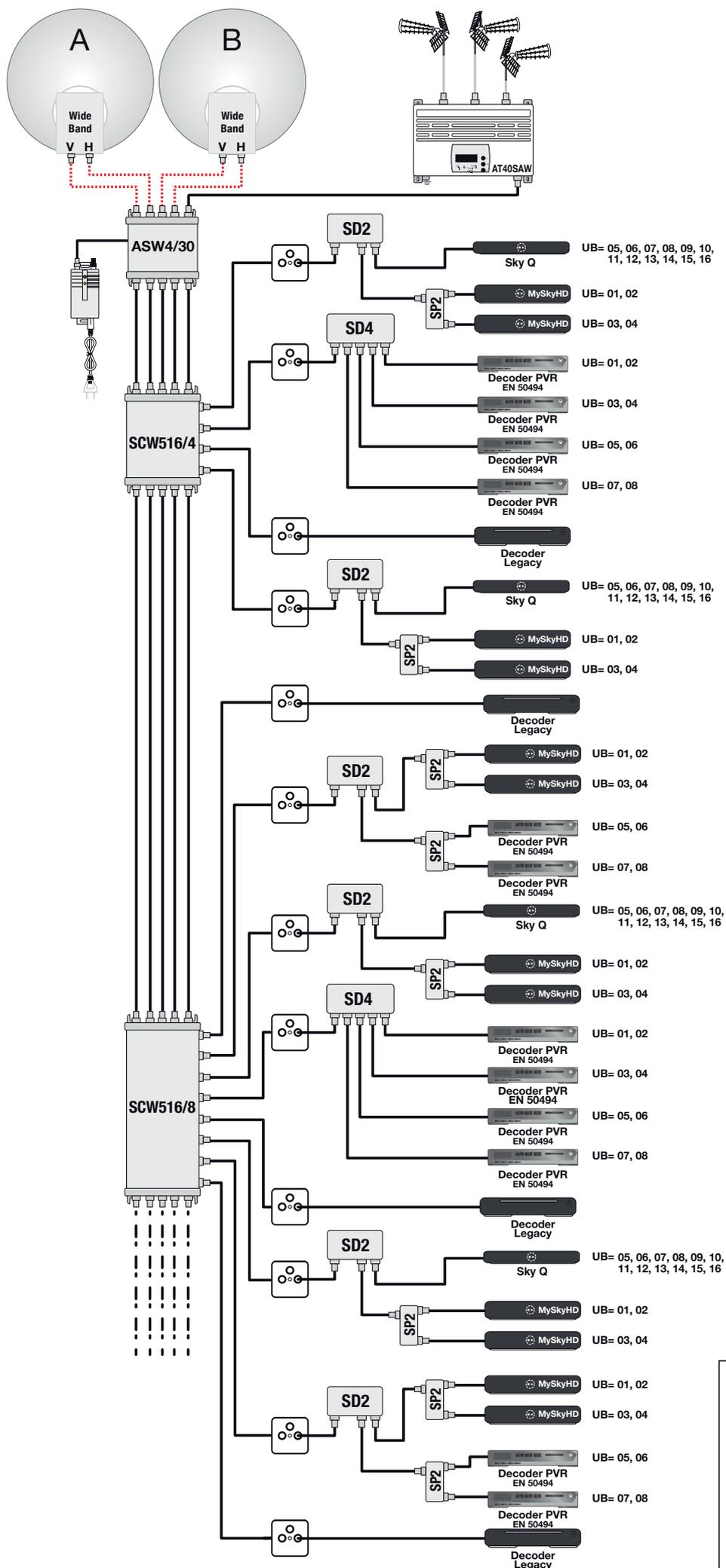
Schema di utilizzo di **SCW516** per la distribuzione in dual feed di due posizioni satellitari.
