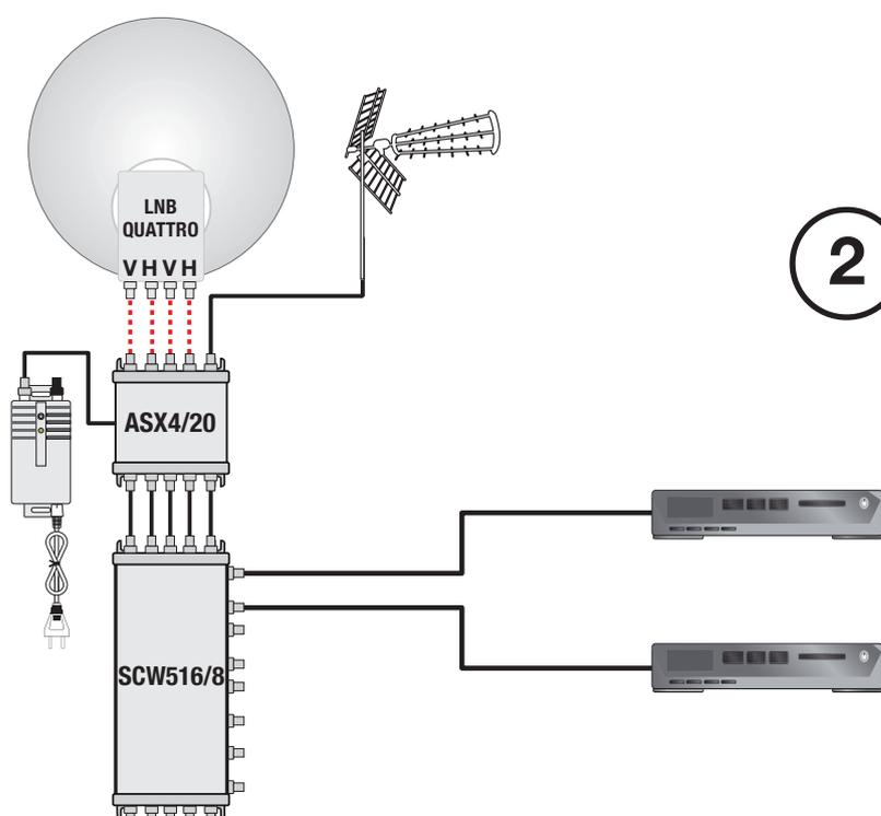
2 L'alimentazione del multiswitch viene fornita dai decoder collegati. L'LNB viene alimentato direttamente dall'amplificatore di testa **ASX4/20**.
