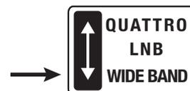
**Nota:** Quando il selettore è posizionato su Wide Band viene attivata anche la linea di telealimentazione sulla polarità Verticale Banda Alta.
