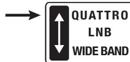
Se l'impianto è stato realizzato con **LNB Wide Band** posizionare il selettore su **WIDE BAND**.
