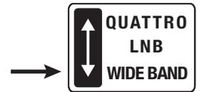
Posizionando il **selettore tipo LNB** presente sul multiswitch SCW416/6 su **WIDE BAND** si abilita la modalità a banda estesa che lo rende idoneo al funzionamento in abbinamento con gli **LNB Wide band LNBWB1**.
