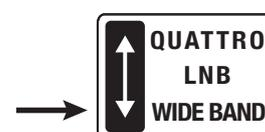
Come al punto precedente posizionando il **selettore tipo LNB** presente sul multiswitch SCW416/6 su **WIDE BAND** si abilita la modalità a banda estesa che lo rende idoneo al funzionamento in abbinamento con gli **LNB Wide band LNBWB1**.
