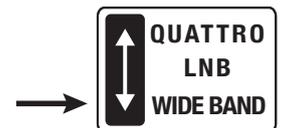
Come al punto precedente posizionando il **selettore tipo LNB** presente sul multiswitch SCW416/6 su **WIDE BAND** si abilita la modalità a banda estesa che lo rende idoneo al funzionamento in abbinamento con gli **LNB Wide band LNBWB1**.
