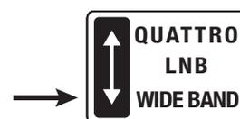
Posizionando il **selettore tipo LNB** presente sul multiswitch SCW416/6 su **WIDE BAND** si abilita la modalità a banda estesa che lo rende idoneo al funzionamento in abbinamento con gli **LNB Wide band LNBWB1**.
