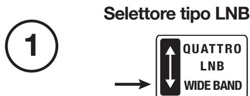
Con gli LNB Wide band sono sufficienti solo due cavi coassiali per un impianto a singolo satellite.
