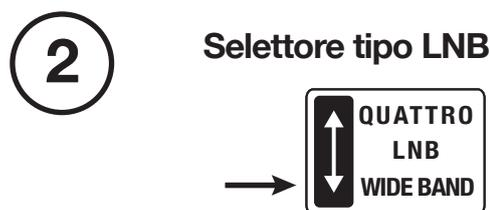
Con gli LNB Wide band sono sufficienti quattro cavi coassiali per un impianto a con due satelliti.
