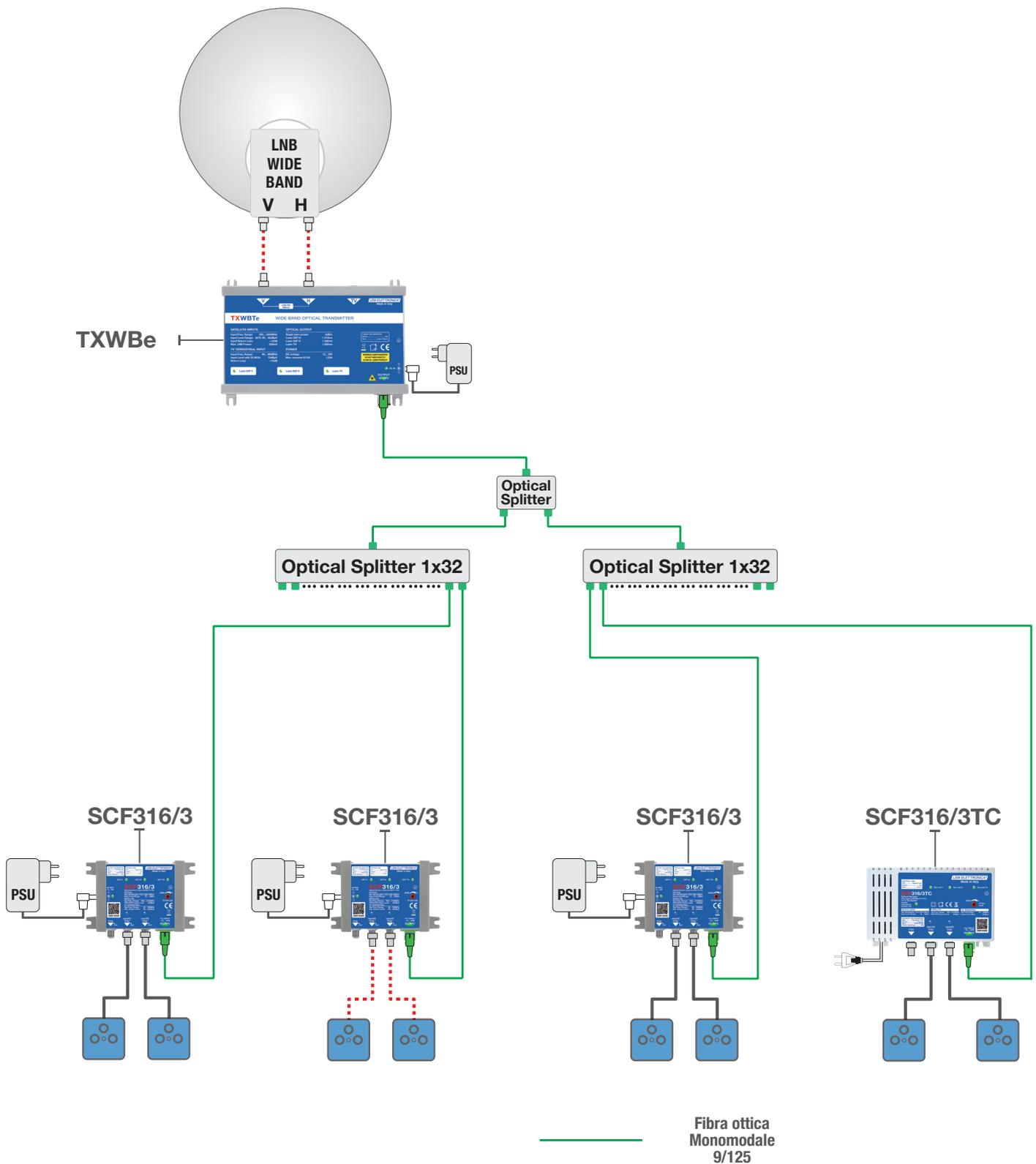
I segnali trasmessi via satellite da una posizione orbitale vengono ricevuti da un LNB Wide Band.
